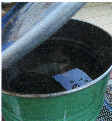
Upp till två procent av perkloretylenet försvinner i kemtvättsavfallet. Resten är bland annat smuts från de tvättade plaggen.
